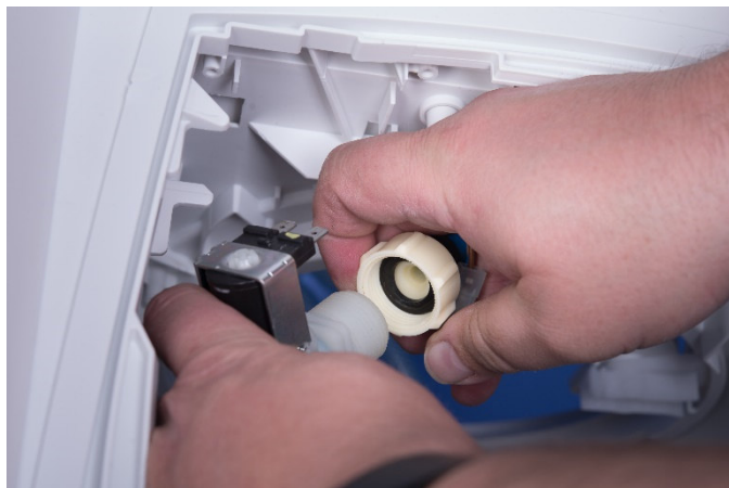
12. Trennen Sie den Frischwasserschlauch von der Frischwasserpumpe. Halten Sie einen Eimer bereit, um im Schlauch stehendes Wasser aufzunehmen.
