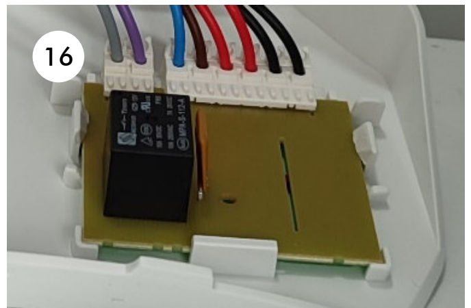
16. Nehmen Sie die Platine aus ihrer Halterung, indem Sie die drei Befestigungsklemmen nach außen drücken.
