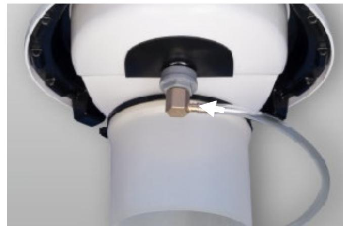
Schneiden Sie dazu durch die Serviceklappe den alten Schlauch über der Schlauchfülle des Winkel-Schlauchanschlusses mit einem Cutter auf, sodass Sie ihn abziehen können.
