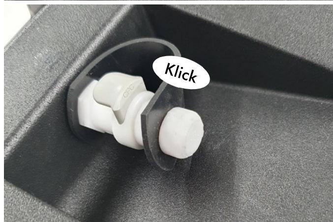
16. Verschließen Sie den Schlauchanschluss für den Transport des Flüssigkeitstanks, indem Sie den mit der Stopfenhalterung an der Kassette befestigten Stopfen hineindrücken, bis er hörbar einrastet.
